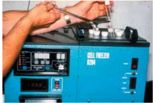
Figur 2. Kontrolleret dybfrysning af embryoner udføres på en Planer fryser i 1978.
